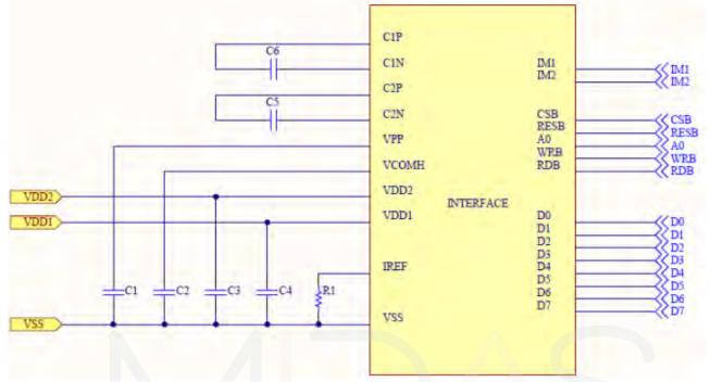
Recommended components : C1, C2, C3, C4 : 4.7uF C5, C6 : 0.22uF
