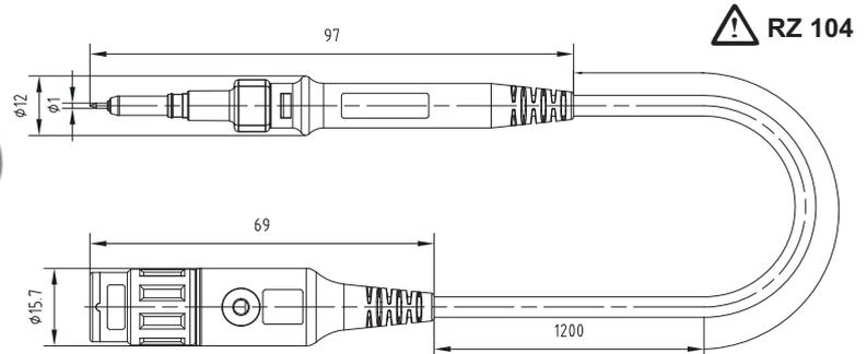
Sicherheits-Hochfrequenz-Tastkopf 100:1 in kompakter Bauform. Durch geringe Eingangskapazität und grossen Eingangswiderstand ist dieser Tastkopf besonders geeignet für Messungen an empfindlichen Schaltkreisen. Hoch flexible, PVC-isolierte koaxiale Anschlussleitung mit BNC-Stecker mit integrierter Kompensationseinheit. Anschlussmöglichkeit für Referenzleitung am Vorderteil des Tastkopfes.
