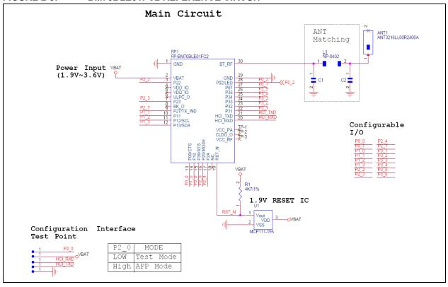
FIGURE 2-4: BM70BLE01FC2 REFERENCE CIRCUIT
