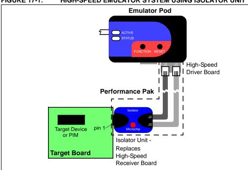
FIGURE 17-1: HIGH-SPEED EMULATOR SYSTEM USING ISOLATOR UNIT
