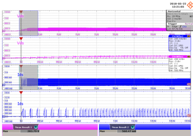
Figure 51 – 85 VAC Input. Upper: V_{DS} , 200 V / div., 2 ms / div. Lower: I_{DS} , 200 mA / div. Zoom: 200 \mu s / div. V_{DS(MAX)} : 283.79 V. I_{DS(MAX)} : 560.47 mA.
