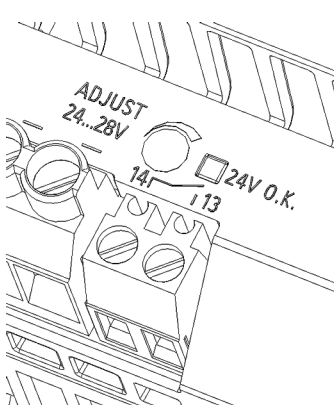
Bild 7: Meldekontakt (3) Figure 7: Signaling contact (3) Figure 7: Contact de signalisation (3) Figura 7: Contatto di segnalazione (3) Figura 7: Contacto de señalización (3)
