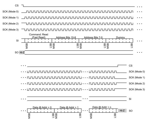
Figure 5-7. SPI Read Access (Command: 0x03 or 0x0B)
