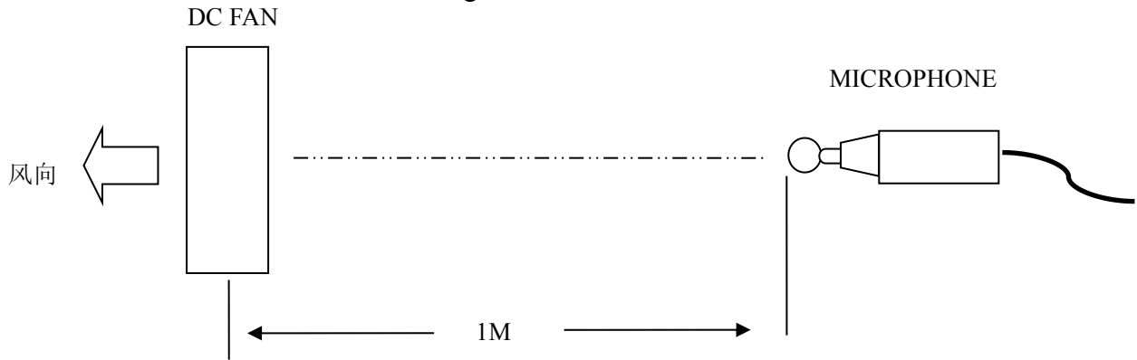
6-1. 噪音测试方法示意图 (Schematic diagram of noise test method) :
