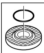
ไอ-ริง (ขั้นพลาสติก) ใส่อยู่ในน็อตรองงาน 8 ดวงรอบบ่า หาก ไอ-ริง หายหรือชำรุด ต้องหาซื้อใหม่มาเปลี่ยนได้ในทุกกรณี (หมายเลขอธิสินค้า 1 600 210 039) ก่อนประกอบน็อตรองงาน 8 เข้า
