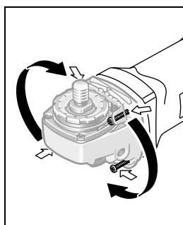
机器操作者可根据需要分段式转动机头，每一段的旋转角度为 90 度。此功能的优点是能够在特殊的工作状况下，把起停开关移动到比较容易操作的位置。例如切割时使用能够配合导引板的吸尘罩 20，或者针对左撇子。
