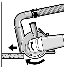
เปิดเครื่องทำงาน และ วางส่วนหน้าของแผ่นสำหรับตัดหินขั้นงาน เคลื่อน เครื่องไปข้างหน้าด้วย ความเร็วพอประมาณที่ เหมาะสมกับรูดชั้นงานที่ กำลังตัดอยู่
