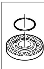
Di dalam flens untuk poros kerja 8 di sekitar tingkatkan pemusatan ada satu bagian dari bahan sintetik (ring-O). **Jika ring-O ini tidak ada atau rusak**, mutlak harus diganti (nomor model 1 600 210 039) sebelum flens untuk poros kerja 8 dipasangkan.
