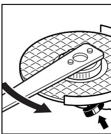
Un écrou de serrage rapide non endommagé qui a été correctement fixé peut être desserré à la main en tournant l'anneau moleté dans le sens inverse des aiguilles d'une montre.
