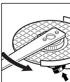
如果安装正确，而且快速螺母未损坏的话，一般可以用手朝著逆时针方向转松快速螺母。
