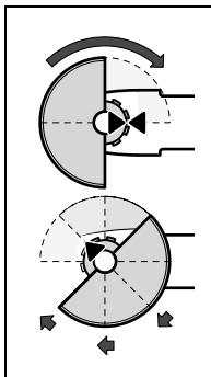
สวมกระเบนป้องกันอันตราย 12 เข้าบนแหวนรัดแกนเครื่องตามภาพประกอบ เครื่องหมายสามเหลี่ยมบนกระเบนป้องกันอันตรายต้องตรงกับเครื่องหมายสามเหลี่ยมบนกระเบนที่อยู่ด้านนอก เกตกระเบนป้องกันอันตราย 12 เข้าบนแหวนรัดแกนเครื่องจากด้านบนของกระเบนป้องกันอันตรายทางทابกับฐานของเครื่อง และหมุนกระเบนสามารถได้ยืนเสียงเข้าล็อกโดยอ้างว้างขั้ดเจน
