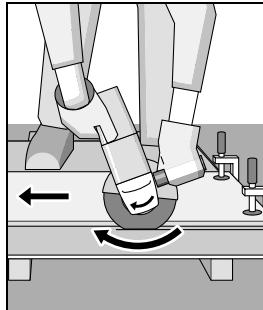
เครื่องต้องทำงานในทิศทาง ตรงกันข้ามกับการหมุน เมื่อ มีตะเข็บจะเกิด อันตรายจากการที่เครื่อง ถูกตัดออกจากกรอบตัด โดยควบคุมไม่ได้ เมื่อต้องการตัดเส้น รอบนอกและที่สี่เหลี่ยม ข้อแนะนำให้รีบตัดรุ่งที่มี หน้าตัดที่เล็กที่สุด
