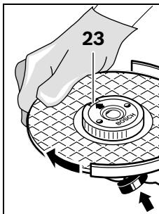
Tekan tombol penahan poros kerja **2** untuk menahan poros kerja. Untuk mengencangkan mur untuk poros kerja yang dibuka dan dikunci dengan tangan, putarkan mata gerinda dalam arah jalannya jarum jam dengan keras.
