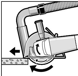
開動電動工具，並把導引裝置的前端放置在工作上。參考工件的物料，適當地施力推進機器。
