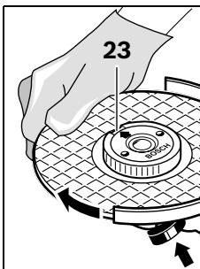
Afin de bloquer la broche d' entraînement, appuyez sur le dispositif de blocage de la broche **2**. Afin de serrer l'écrou de serrage rapide, tournez fortement la meule dans le sens des aiguilles d'une montre.
