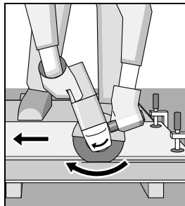
Máy luôn luôn phải được vận hành theo chuyển động mài ở tư thế thẳng đứng. Nếu không như vậy, có sẵn nguy cơ bị đẩy mà **không điều khiển** được máy ra khỏi mạch cắt.
