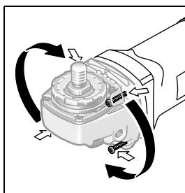
หัวเครื่องสามารถหมุนทำมุมกับตัวแม่กลิ่งเครื่องได้เป็นขั้นขั้นละ 90° ในลักษณะนี้สิทธิ์ปิด-ปิดสามารถเลื่อนไปมาอุ่นๆ ตามตำแหน่งที่สะดวกของการใช้งานมากขึ้นเมื่อทำงานในสถานการณ์พิเศษ ต. ย. เช่น สำหรับการตัดที่ใช้แผ่นนำการตัดพร้อมไม้ครอบดูดฝุ่น 20 หรือสำหรับผู้คนมือซ้าย
