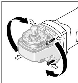
Kepala mesin dapat diputarkan dalam langkah masing-masing sebesar  $90^\circ$ . Dengan demikian untuk berbagai pekerjaan yang khusus, tombol untuk menghidupkan dan mematikan mesin bisa diganti
