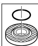
在固定法蘭 8 的定心軸環上有一個塑料零件（O形環）。如果缺少 O形環或 O形環損壞了，必須在安裝固定法蘭 8 之前，換上新的 O形環（O形環的物品代碼：1 600 210 039）。
