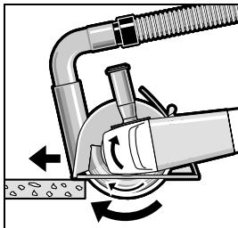
开动电动工具，并把导引装置的前端放置在工件上。参考工件的物料，适当地施力推进机器。
