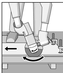
必須逆著機器的轉向推動電動工具，否則容易失控，並導致電動工具從切線中滑出。
