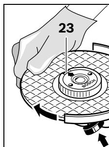
Khóa trực máy mài bằng nút khóa trực máy 2. Để siết chặt dai ốc khóa nhanh, xoay thật chặt đĩa mài theo chiều đồng hồ.
