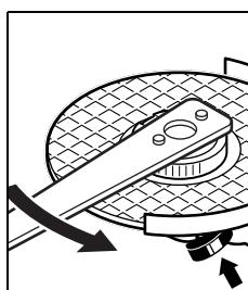
如果安裝正確，而且快速螺母未損壞的話，一般可以用手朝著逆時針方向轉松快速螺母。
