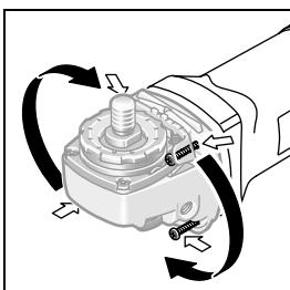
Đầu máy có thể xoay được đối với vỏ máy ở vào  $90^\circ$  nắc. Bằng cách này, công tắc Tắt/Mở có thể mang lại vị trí thuận lợi hơn đối với các tinh huống gia công đặc biệt, vd., gia công cắt có sử dụng dưỡng
