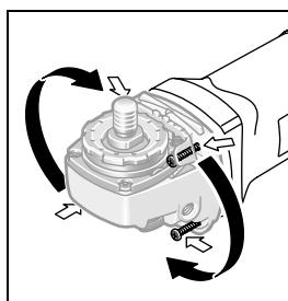
Il est possible de faire pivoter le carter d'engrenage par paliers de 90°. Ceci permet de mettre l'interrupteur Marche/Arrêt dans une position de maniement favorable à des utilisations spécifiques, p. ex.
