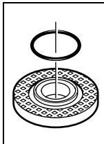
Vòng đệm chữ O (bộ phận bằng nhựa) được lắp vào bích lắp dụng cụ 8 vòng quanh vòng tâm của bích lắp. Nếu vòng đệm chữ O bị mất hay bị hư, vòng phải được thay vào bằng mọi cách (mã số 1 600 210 039) trước khi bích lắp dụng cụ 8 được lắp vào.
