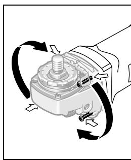
機器操作者可根據需要分段式轉動機頭，每一段的旋轉角度為 90 度。此功能的優點是能夠在特殊的工作狀況下，把起停開關移動到比較容易操作的位置。例如切割時使用能夠配合導引板的吸塵罩 20，或者針對左撇子。
