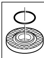
Le flasque de fixation 8 est doté d'une pièce en matière plastique (rondelle élastique) se trouvant autour de l'ergot de centrage. **Au cas où cette rondelle élastique ferait défaut ou qu'elle serait endommagée**, il faut absolument la remplacer (Référence 1 600 210 039) avant de monter le flasque de fixation 8.
