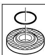
在固定法兰 8 的定心轴环上有一个塑料零件（O 形环）。如果缺少 O 形环或 O 形环损坏了，必须在安装固定法兰 8 之前，换上新的 O 形环（O 形环的物品代码：1 600 210 039）。
