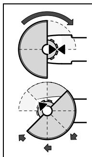
参考插图把防护罩 12 安装在主轴颈上。防护罩上的三角形记号，必须和机器传动头上的三角形记号相对。
