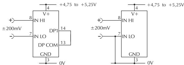
Misurazione di una tensione in ingresso in relazione con un'alimentazione flottante, ovvero la tensione in ingresso e l'alimentazione dello strumento di misura vengono isolate l'una dall'altra. Assicurarsi che la connessione a saldatura a 2 sia chiusa.
