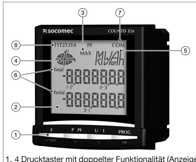
1. 4 Drucktaster mit doppelter Funktionalität (Anzeige oder Konfiguration)
