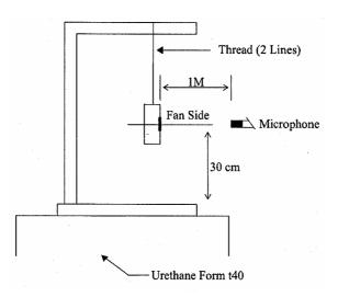
1 METER FROM MICROPHONE TO FAN INTAKE
