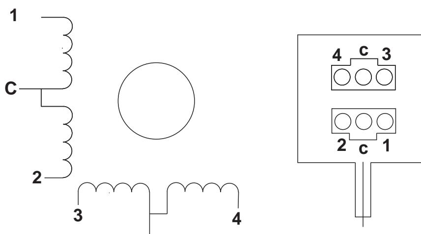
Suitable drive boards connections / Anschlüsse geeigneter Treiberplatten / Carte d'entraînement 2A unipolaire /
