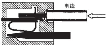
④拔出螺丝刀后电线会被弹簧固定，此时即连接完毕。
