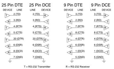
Figure 3.1. DTE/DCE Port Diagrams
